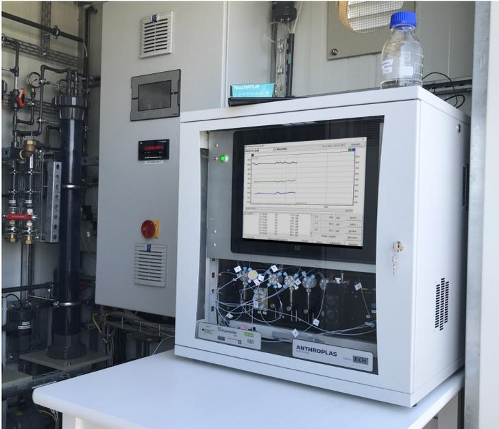
Der ANTHROPLAS ist das erste vollautomatische Analysensystem, das anthropogene Mikroschadstoffe im Wasser detektiert. Das Gerät basiert auf einem neuartigen, biosensorischen Messverfahren. Es wurde für den Einsatz im Labor und in der vierten Reinigungsstufe von Kläranlagen entwickelt.
